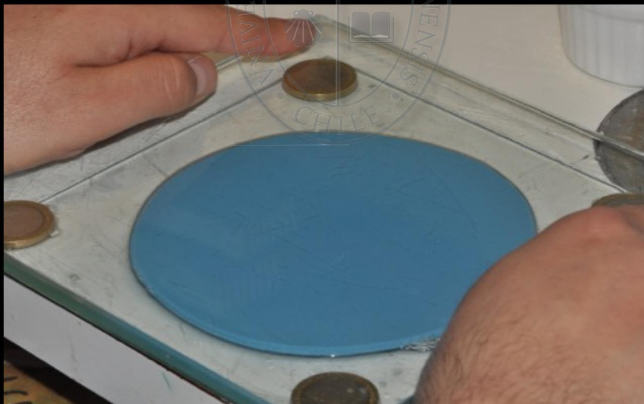
**Presione con la otra loseta, hasta obtener una lámina del grosor de las monedas**
