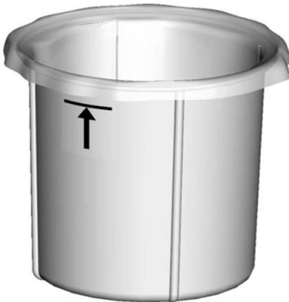
5. Llene el depósito con agua hasta la marca del nivel de llenado (aprox. 16 litros).
