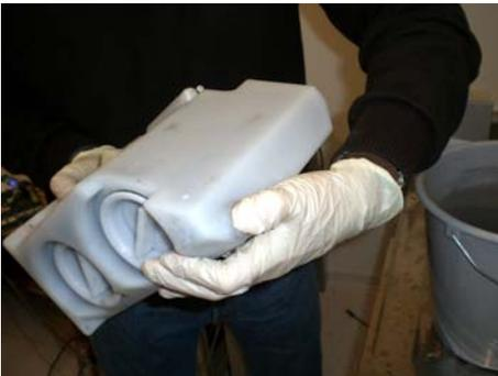
3. Abra el orificio de desagüe (D). Incline el depósito sin que salga líquido por el orificio de desagüe.
