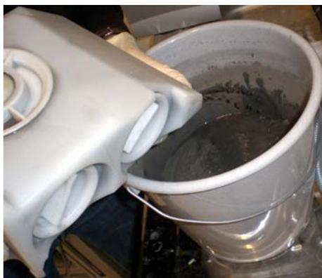
5. Vacíe aprox. 1/3 del contenido del depósito en el recipiente colector preparado a tal efecto. Para facilitar el vaciado, se puede accionar además el resorte del orificio de entrada de la tapa del depósito (B).
